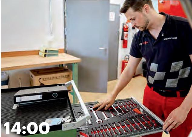
◀ Nach jeder Reparatur oder Kontrolle prüft er seine Werkzeugkiste auf Vollständigkeit. Jeder Mechaniker hat seine eigene Kiste, und auf keinen Fall darf etwas fehlen. So ist sichergestellt, dass kein Werkzeug im Helikopter liegen bleibt und später während eines Fluges zu Problemen führen könnte.
